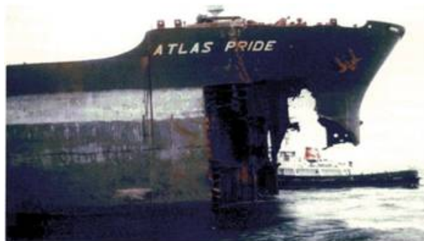
Рис. 2. Значительные повреждения корпуса в носовой оконечности при бортовом слеминге
