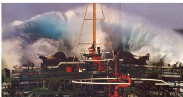
Рис. 1. Удар сопровождается интенсивным брызгообразованием при днищевом слеминге
