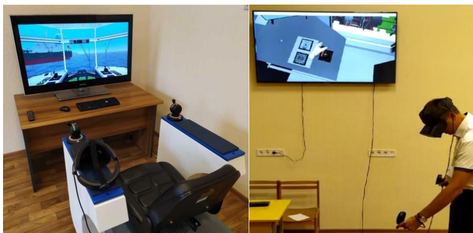
Рис. 3. Варіанти тренажера ASD буксира в положенні сидячи і стоячи
