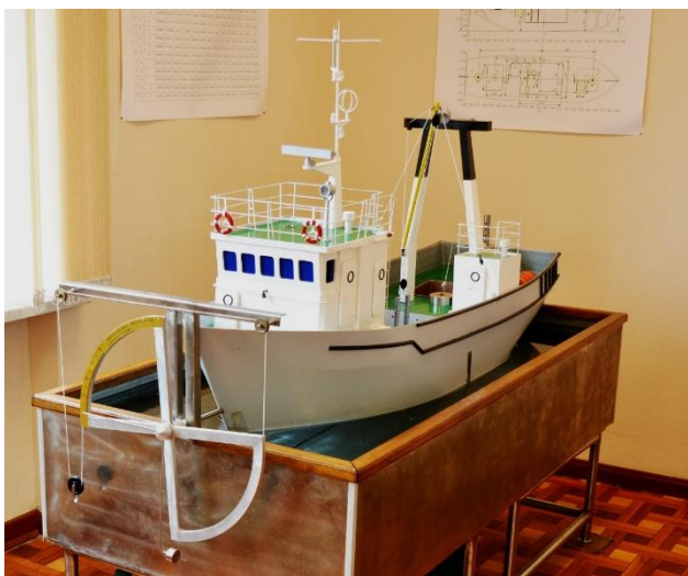
Рис. 1. Експериментальна установка для дослідження морехідних якостей судна
