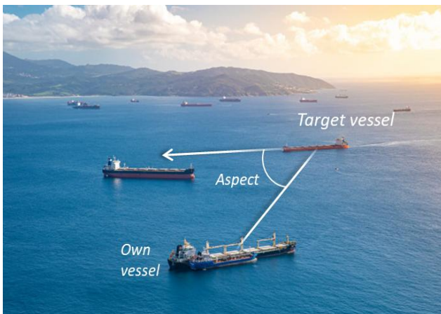
Рис. 1. Схема визначення ракурсу цільового судна відносно судна-спостерігача
